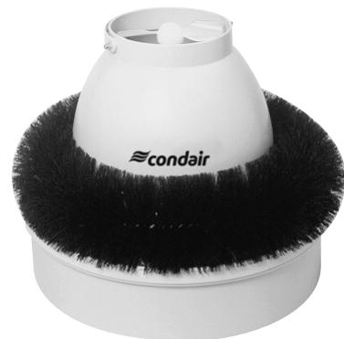
Diese Filterbürste ist auf einem Aluminiumring befestigt, der über den Apparat auf das 6-Liter-Becken aufgesetzt werden kann. Das Apparatekabel ist durch den Ring durchzuziehen. Die vom Apparat benötigte Luft muss dann zwangsläufig die Filterbürste passieren, wo der Faserstaub zurückgehalten wird. Damit wird die Verschmutzung des Apparates weitgehend behindert und entsprechend kann auch die Wartung (Reinigung des Siebes, Reinigung des Apparates) auf längere Zeitperioden ausgedehnt werden.
