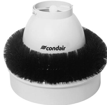
Cette brosse à filtrer est montée sur un anneau d'aluminium qui peut être emboité au-dessus de l'appareil, sur le récipient de 6 litres. Le câble électrique de l'appareil doit être passé à travers l'anneau. L'air dont le Condair a besoin est forcé de passer par la brosse-filtre qui retient la poussière de fibre. Ceci empêche efficacement l'appareil de s'encaisser et l'entretien (nettoyage du filtre et de l'appareil) peut être effectué à intervalles plus espacés.
